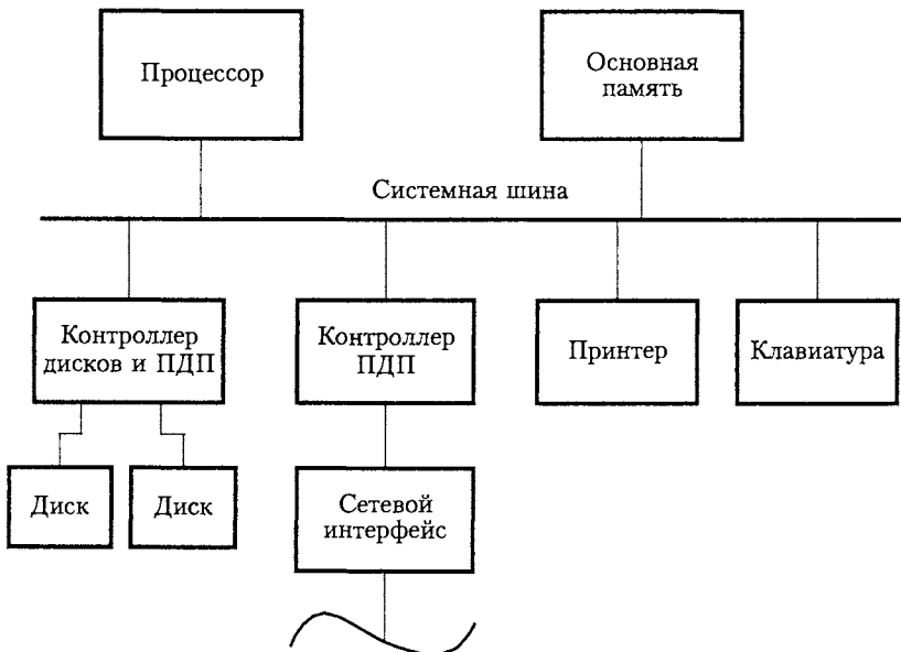
Рис. 4.19. Использование контроллеров ПДП в компьютерной системе
