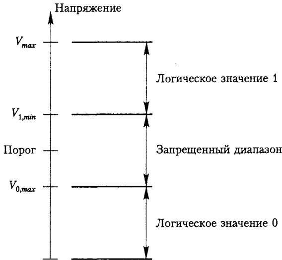
Рис. А.10. Представление логических значений посредством уровней напряжения
