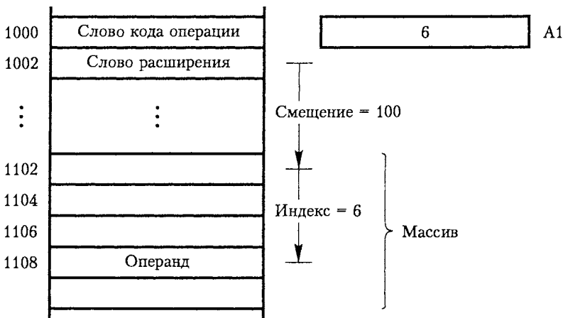
Рис. 3.20. Пример полной относительной адресации процессора 68000 для команды ADD 100(PC,A1)D0
