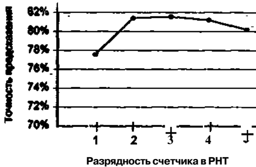
Рис. 9.15. Зависимость точности предсказания от разрядности элементов РНТ
