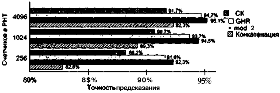
Рис. 9.24. Зависимость точности предсказания от способа доступа к РНТ и размера таблицы
