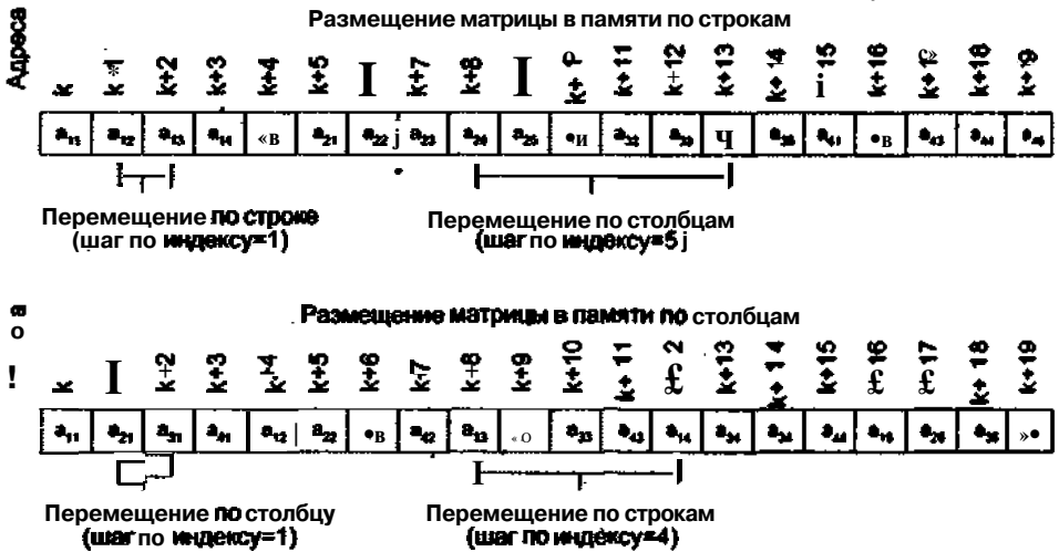
Рис. 13.3. Способы размещения в памяти матрицы 4x5
