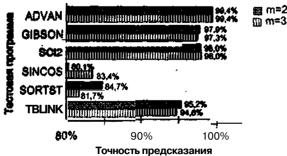
Рис. 9.16. Точность предсказания при использовании в РНТ двухразрядных и трехразрядных счетчиков
