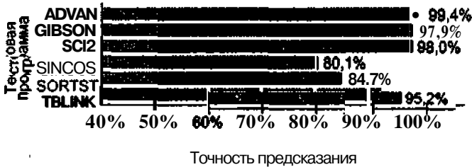
Рис. 9.30. Точность предсказания двухразрядной бимодальной схемы [197]
