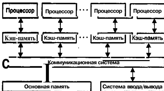
Рис. 14.3. Организация симметричной мультипроцессорной системы
