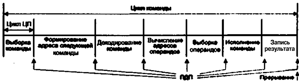
Рис. 8.10, Точки возможного вмешательства в цикл команды при прямом доступе к памяти и при обычном прерывании
