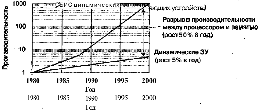
Рис. 1.14. Разрыв в производительности процессоров и динамических запоминающих устройств
