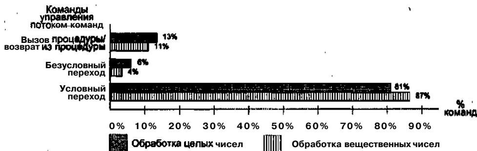
1 Рис. 2.34. Частота использования команд управления потоком команд
