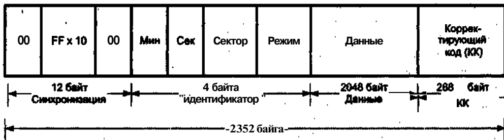
Рис. 5.48. Формат блока CD-ROM
