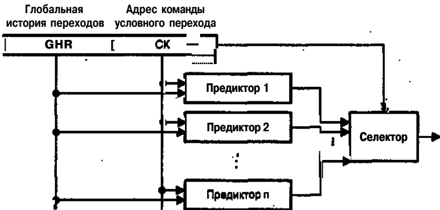
Рис. 9.33. Общая схема гибридного предиктора
