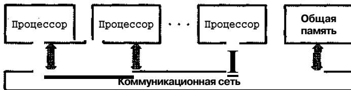
Рис 1.5. Структура вычислительной системы с общей памятью
