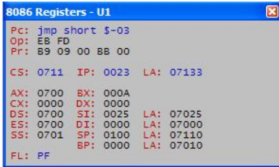
Рис. 10.3. Програмна модель мікропроцесора 8086 у системі Proteus
