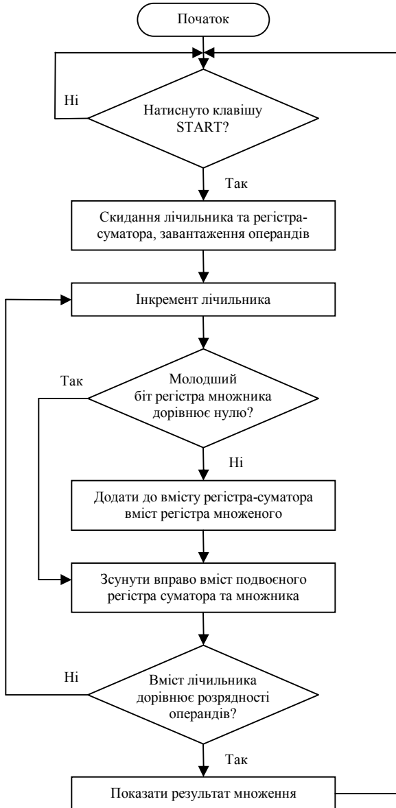
Рис. 5.5. Блок-схема алгоритму роботи пристрою множення
