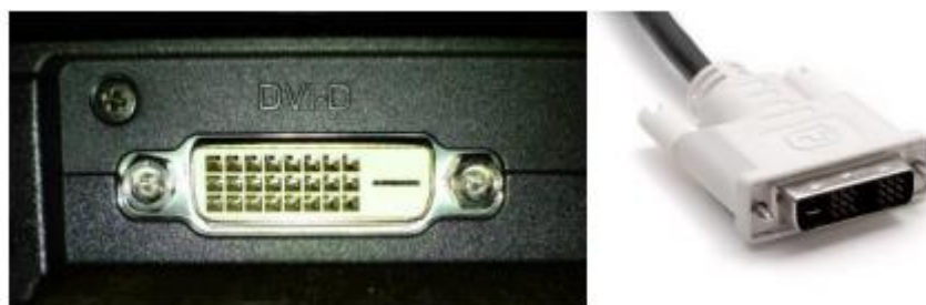
Рис. 11.14. Роз'єм монітора DVI і штекер підключення
