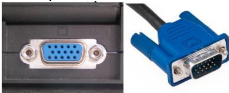
Рис. 11.13. Роз'єм монітора VGA і штекер підключення
