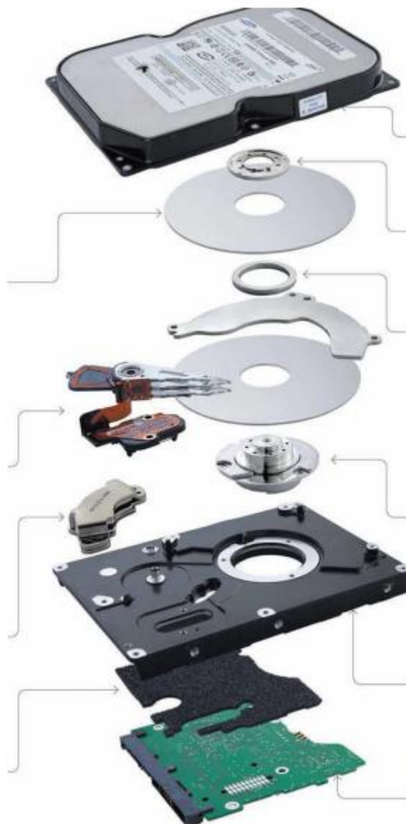
Рис. 9.22. Складові жорсткого диску
