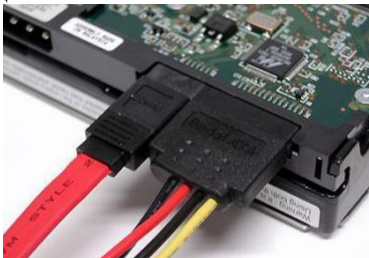
Рис. 9.21. Підключення SATA пристрою
