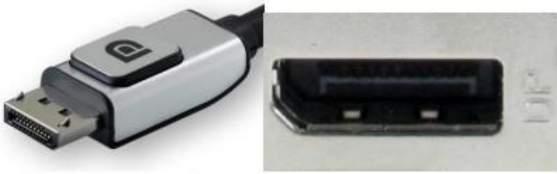
Рис. 11.16. Роз'єм монітора DisplayPort і штекер підключення
