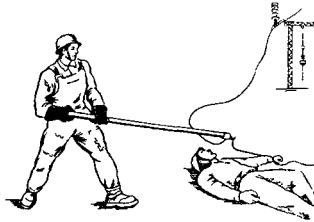
Рис 3.30. Звільнення потерпілого від дії струму в електроустановках напругою понад 1000 В ізолюючою штангою
