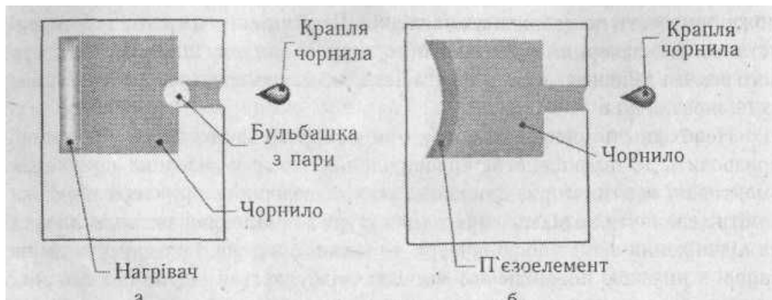
Рис. 2.12. Сопло друкуючої головки струменевого принтера: а — бульбачкового; б — п'єзоелектричного
