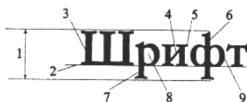
Рисунок 3.1 - Основні елементи шрифту: 1 -кегель; 2 — лінія шрифту; 3 — основний штрих; 4 — сполучний штрих; 5 — зарубка; 6— верхній виносний елемент; 7 — нижній виносний елемент; 8 — внутрішньолітерний просвіт; 9 — наплив.
