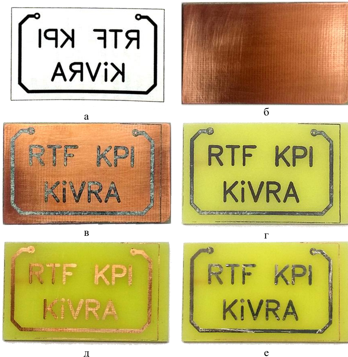
Рисунок 4.1 — Ілюстрація етапів виготовлення друкованої плати: а — роздрукований провідниковий рисунок, б — склотекстолітова заготовка, в — перенесений рисунок на плату, г — витравлена плата, д — плата зі знятим тонером, е — залуження провідникових доріжок
