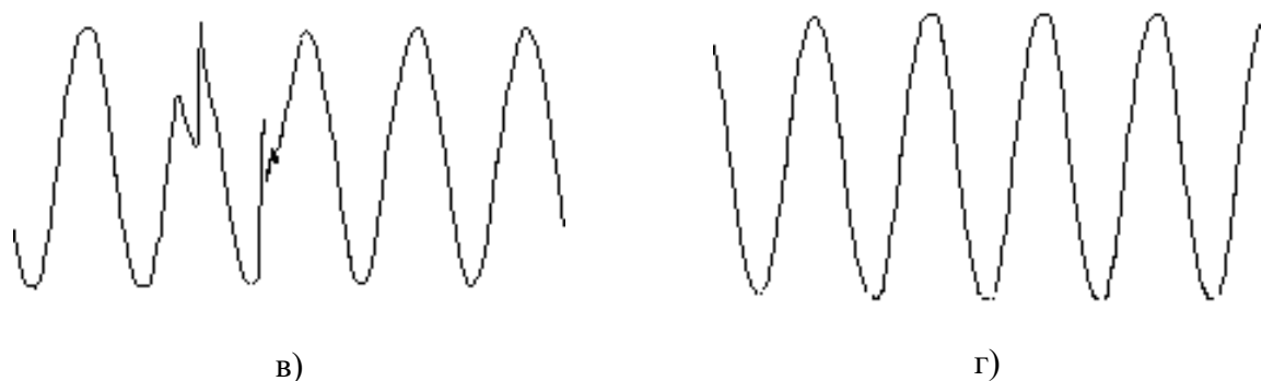
Рис. 8.5. Осцилограми переходу з режиму роботи від мережі на режим роботи від акумулятора (а,б,в) і навпаки (г)
