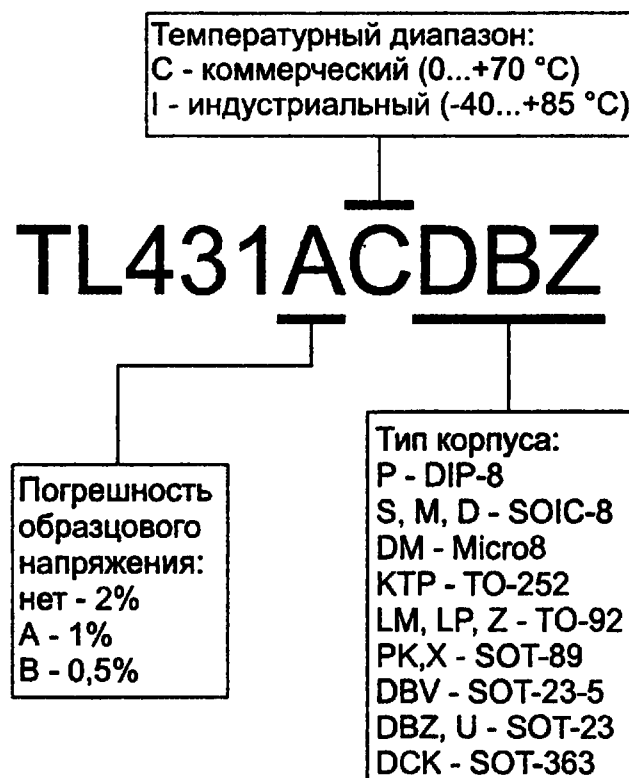
Рис. 3.3. Цоколевка микросхем TL431 разных производителей
