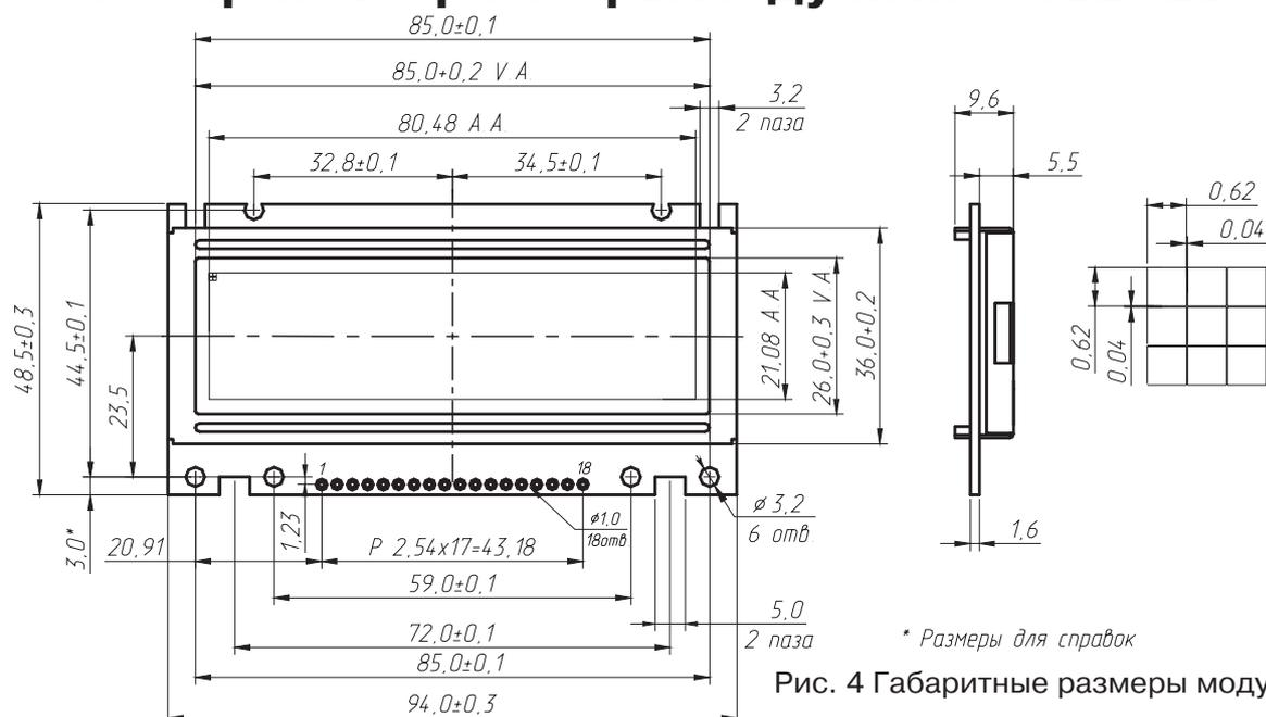
Рис. 4 Габаритные размеры модуля.
