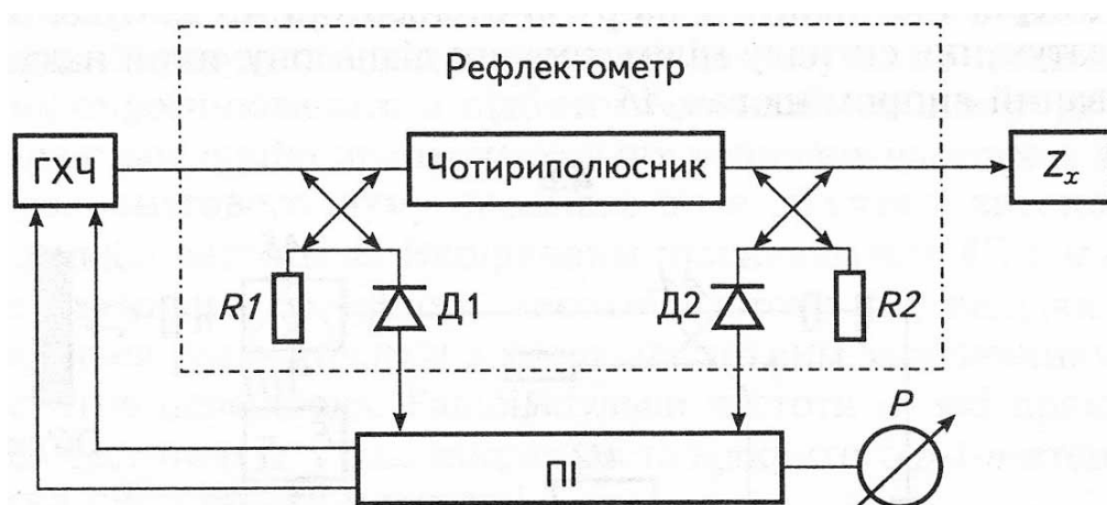
Рис. 4.7. Схема вимірювання ослаблення чотириполосника
