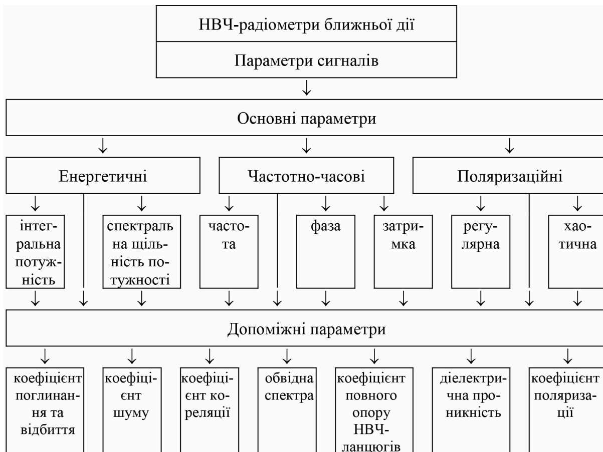
Рис. 1.3. Класифікація параметрів сигналів НВЧ-радіометрії
