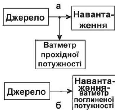
Рис. 10.3. Блок-схема вимірювання потужності НВЧ
