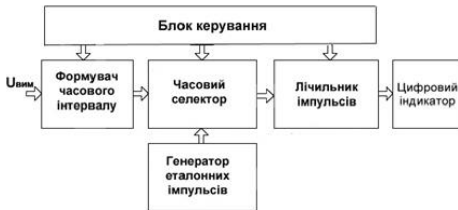
Рис. 7.1. Структурна схема вимірювача часових інтервалів
