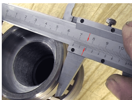
Рис. 3.12. Розмір, отриманий при вимірюванні штангенциркулем, дорівнює 67,18 мм
