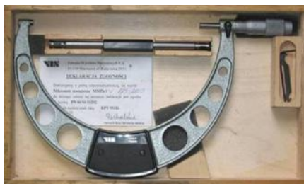
Рис 5.9. Мікрометр з круговою шкалою для зовнішніх вимірювань і діапазоном вимірювання 175 – 200 мм, із ціною поділки 0,01 мм
