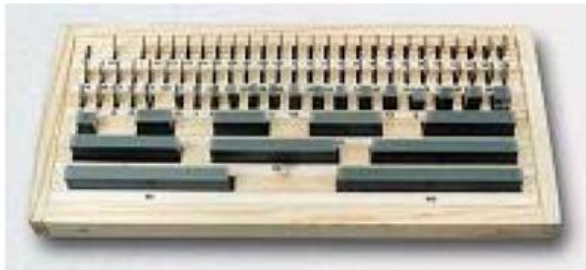
Рис. 5.1. Набір № 1 плоскопаралельних кінцевих мір довжини
