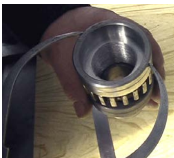
Рис. 3.6. Вимірювання зовнішніх розмірів деталі кронциркулем
