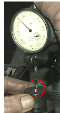
Рис. 3.25. Сприймальний елемент індикатора
