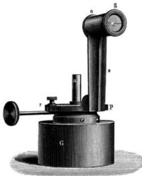
Рис. 2.2. Лампа Хефнера – еталон «свічки Хефнера»
