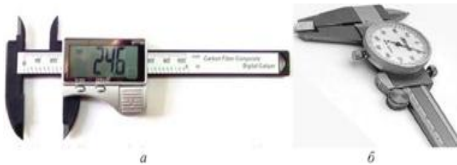
Рис. 5.6. Штангенциркуль: цифровий (а), зі стрілочним індикатором (б)
