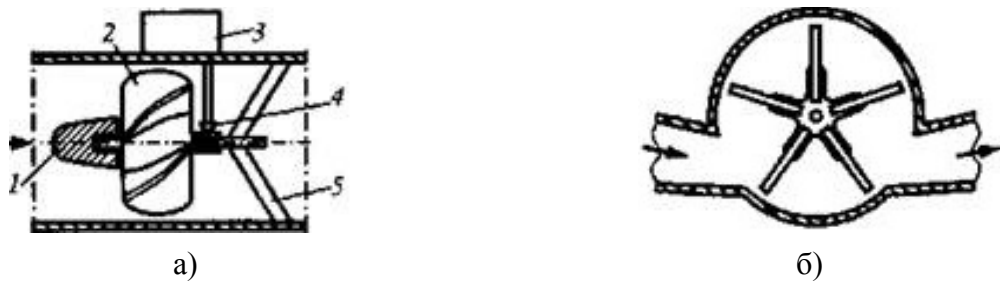
Рис. 15.6 – Швидкісні лічильники з аксіальною (а) і тангенціальною (б) турбінками: 1 – струмененапрямяч; 2 – турбінка; 3 – механічний лічильний пристрій; 4 – передавальний механізм; 5 – опори.
