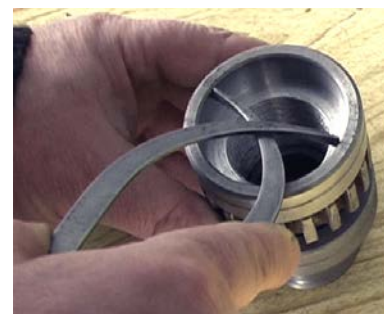
Рис. 3.7. Вимірювання внутрішніх розмірів деталі кронциркулем
