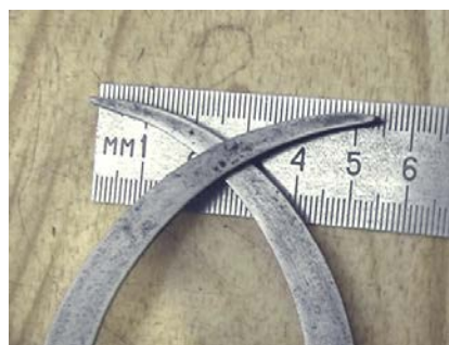
Рис. 3.9. Читання показань при вимірюванні кронциркулем
