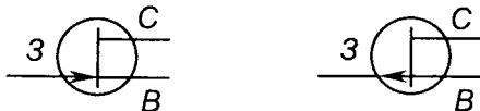
Рис. 2.27 – Умовні позначення ПТ з керуючим p - n переходом: а) з каналом n -типу, б) з каналом p -типу
