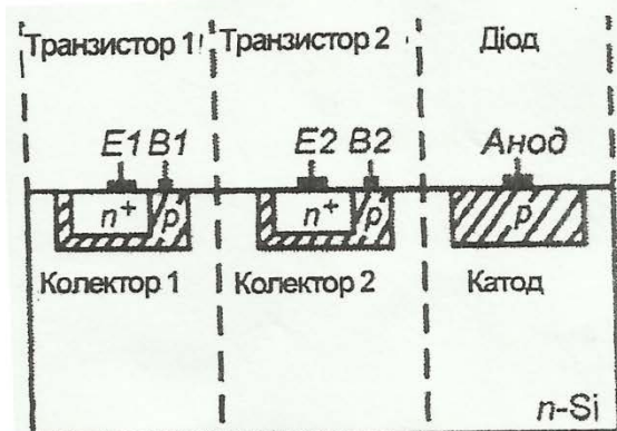
Рис.4.9,а. Внутрішній зв'язок елементів біполярних ІМС крізь підкладку
