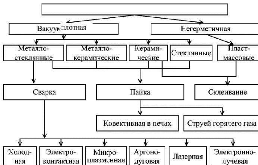
Рис. 43. Класифікація методів і способів герметизації НІМ в корпуси
