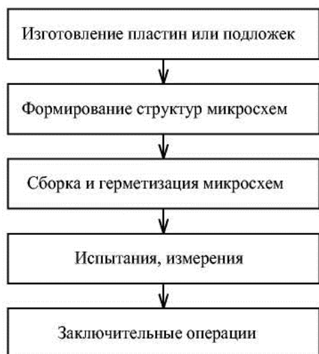
Рис. 2. Етапи виготовлення мікросхем
