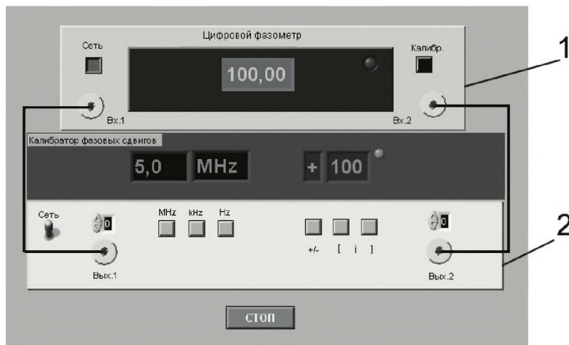
Рис. 3.7.3. Модель лабораторного стенда на рабочем столе компьютера при выполнении работы 3.7 (1 – цифровой фазометр, 2 – калибратор фазовых сдвигов)
