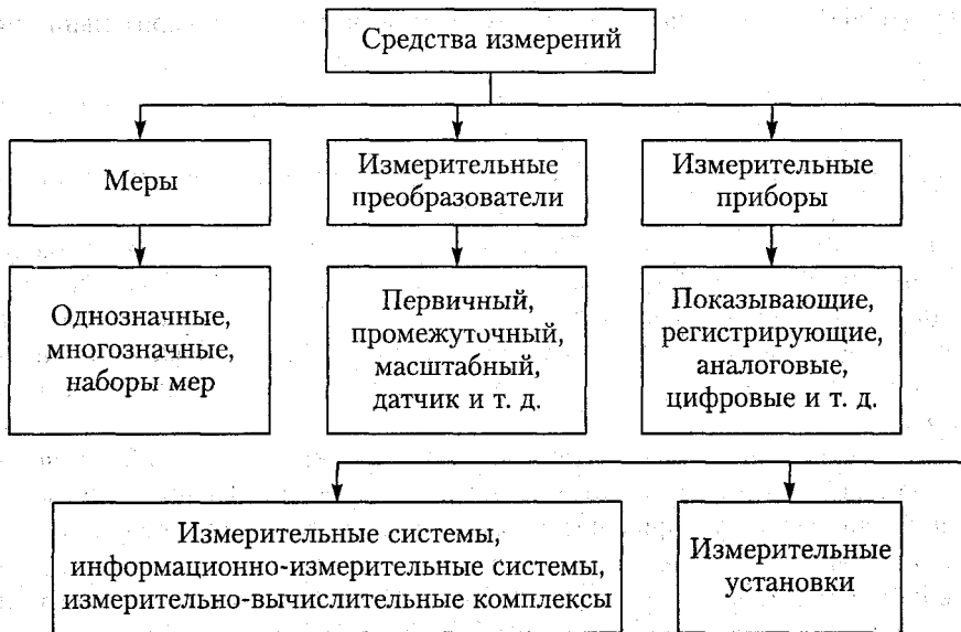
Рис. 3.1. Классификация средств измерений по роли в процессе измерения и выполняемым функциям
