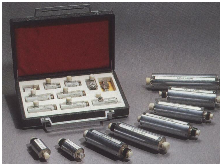
Рисунок 5.8 – Комплект еталонних термоелектричних перетворювачів с додатковими резисторами зі складу ДЕ Росії
