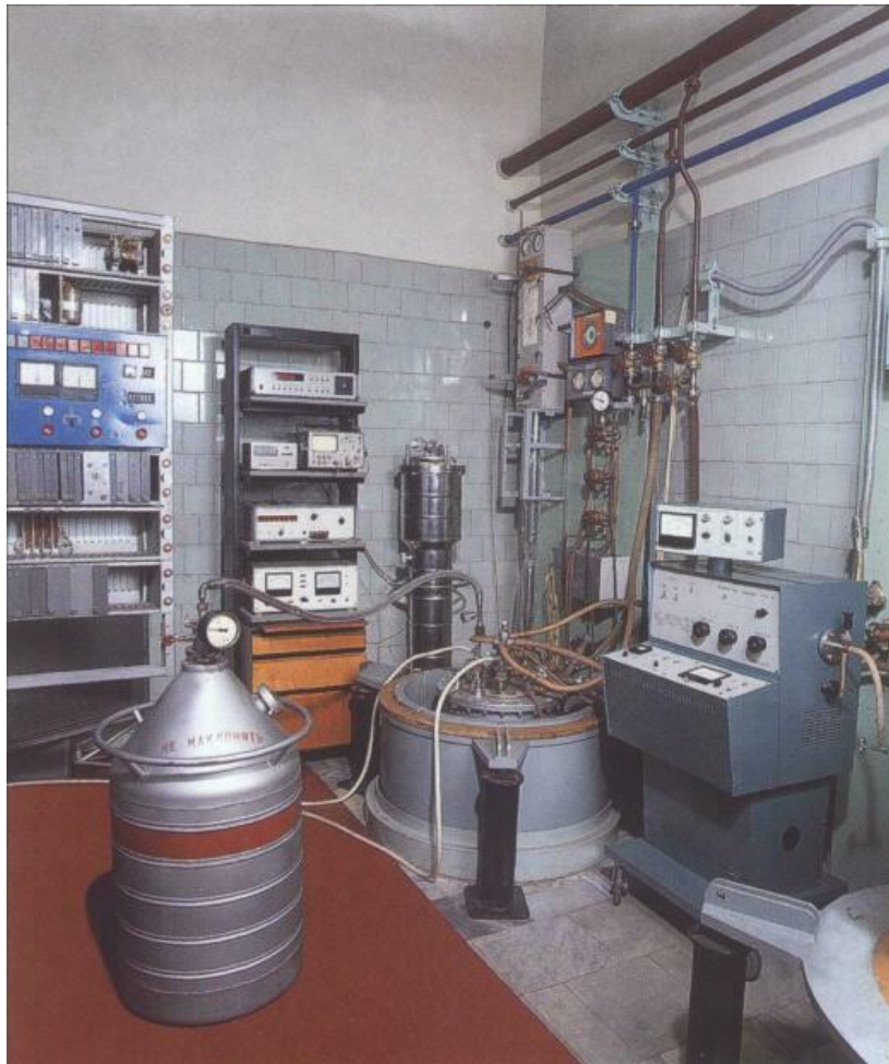
Рис. 4.18. Державний первинний еталон одиниці електричного опору (ВНИИМ)
