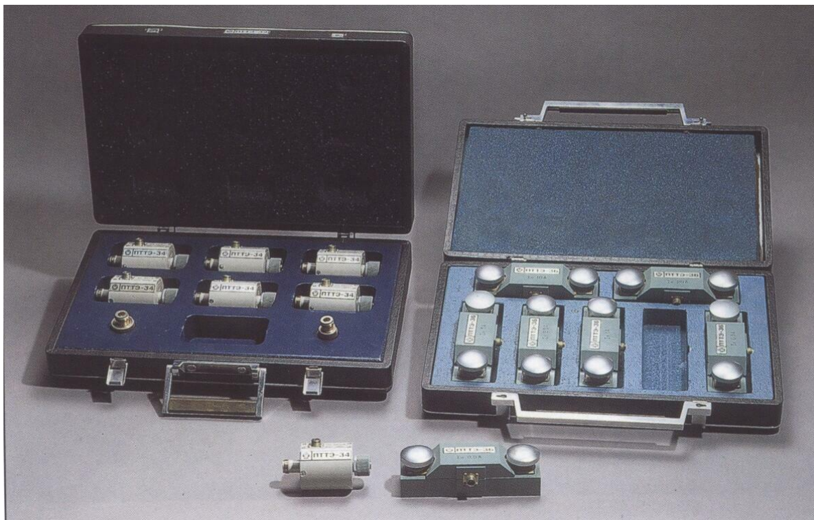
Рис. 5.22. Комплект еталонних термоелектричних перетворювачів змінного струму
