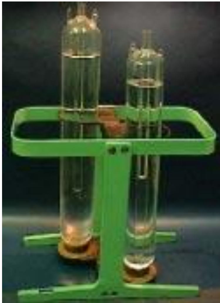
Рис. 3.18. Пристрій, що відтворює потрійну точку води (ВНИИМ), виготовлений з кварцу і заповнений водою вищого ступеня очищення
