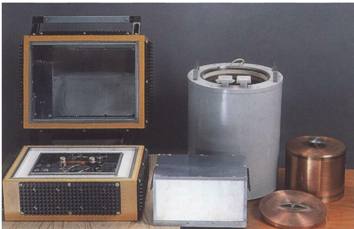
Рис. 6.8. Калориметричний компаратор для частот 0,03 – 37,5 ГГц
