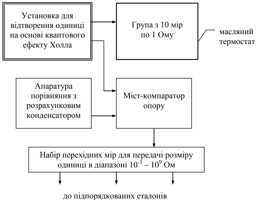
Рис. 4.17. Структурна схема первинного еталона електричного опору
