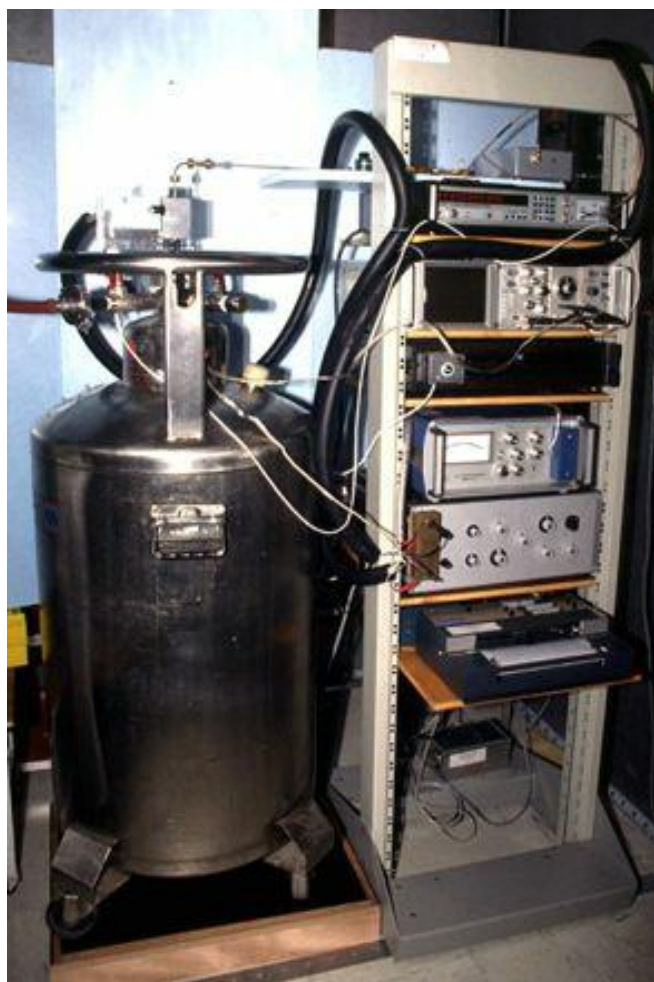
Рис. 4.12. Транспортбельний еталон вольт на ефекті Джозефсона (МБМВ)
