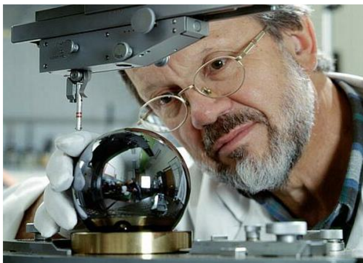
Рис. 9.2. Виготовлення кремнієвої кулі у Австралійському центрі прецизійної оптики
