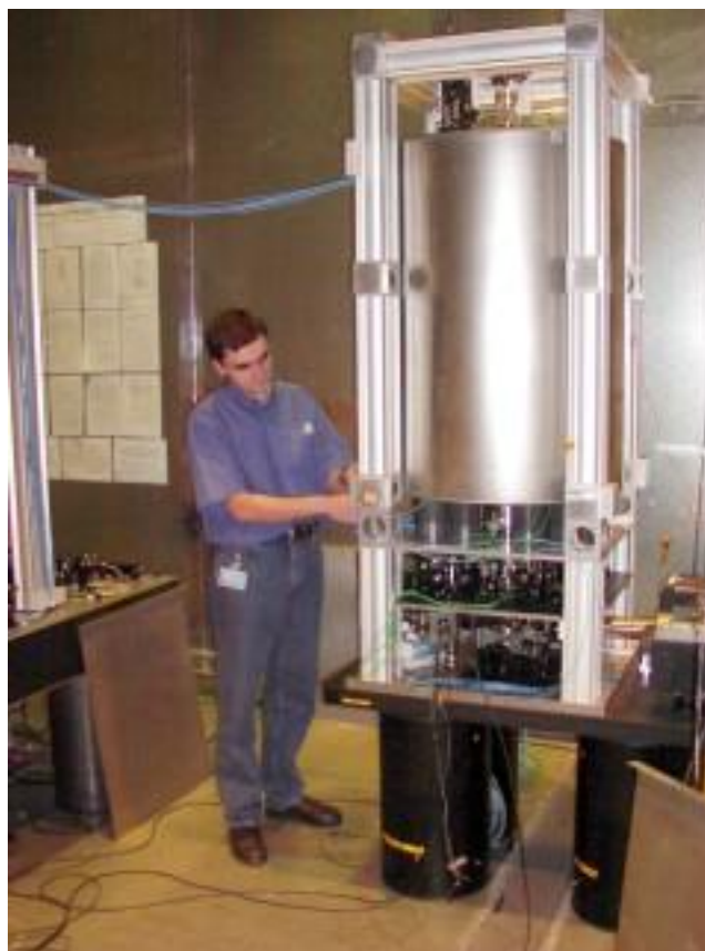
а б Рис. 3.3. Цезієвий фонтан NPL*: а – структурна схема; б – зовнішній вигляд
