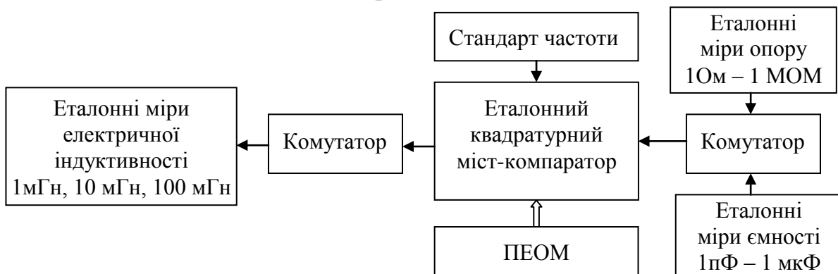
Рис. 7.14. Структурна схема еталона індуктивності України
