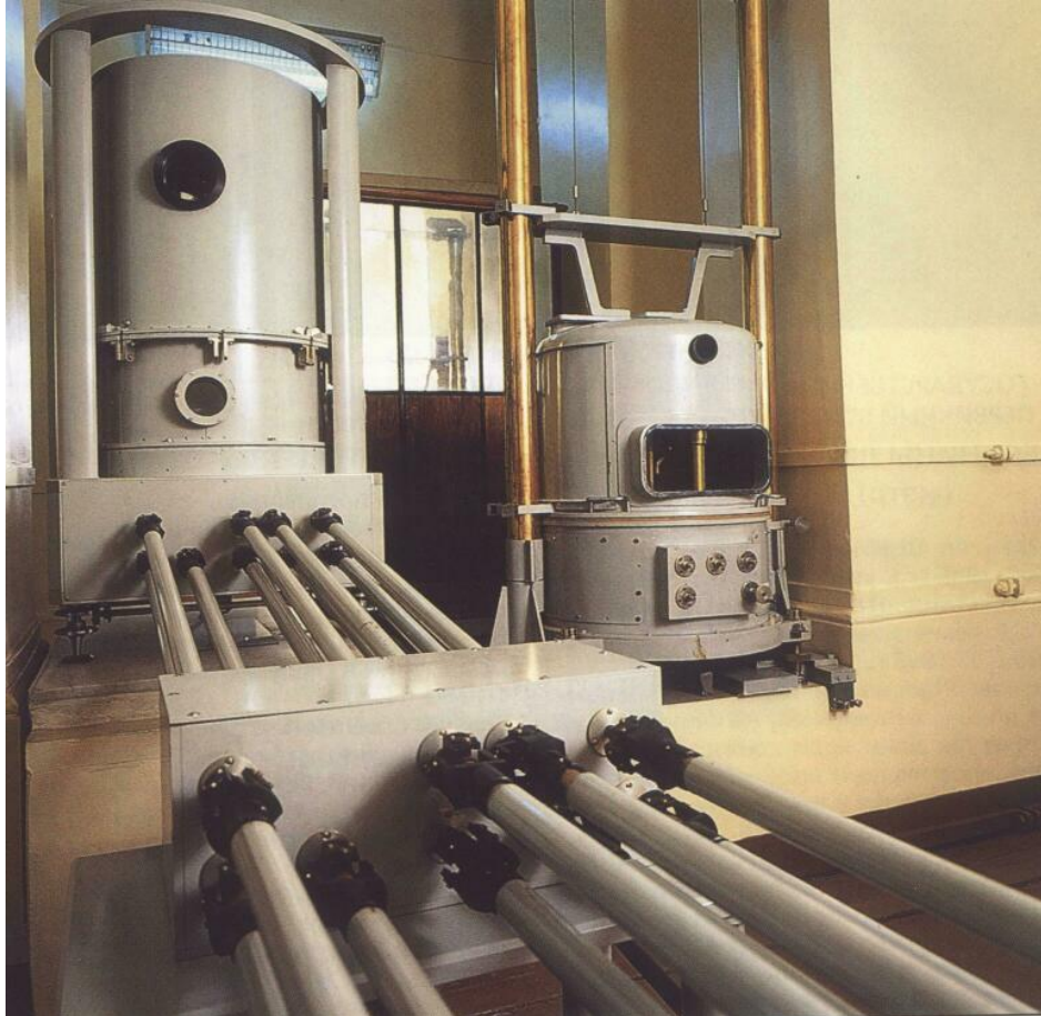
Рис. 3.27. Еталонні ваги з найбільшою межею зважування 1 кг
