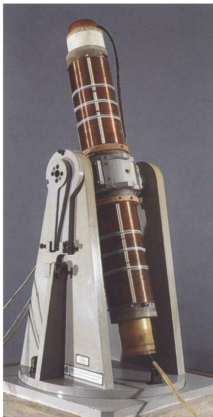
Рис. 4.23. Блок еталонної струмової котушки
