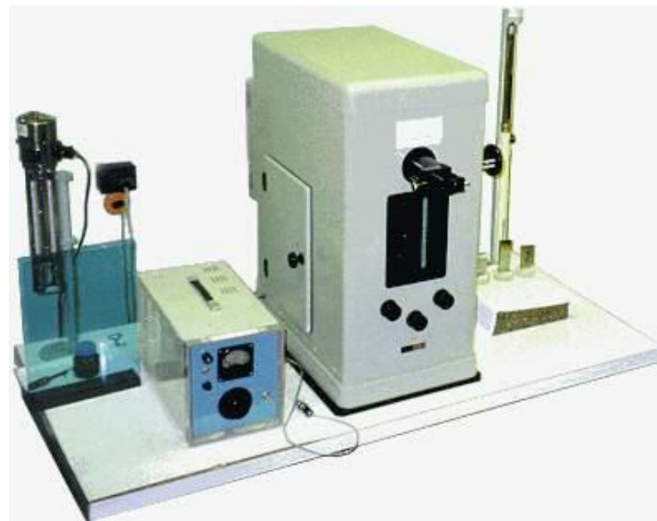
Рис. 3.10. Криптоновий еталон метра
