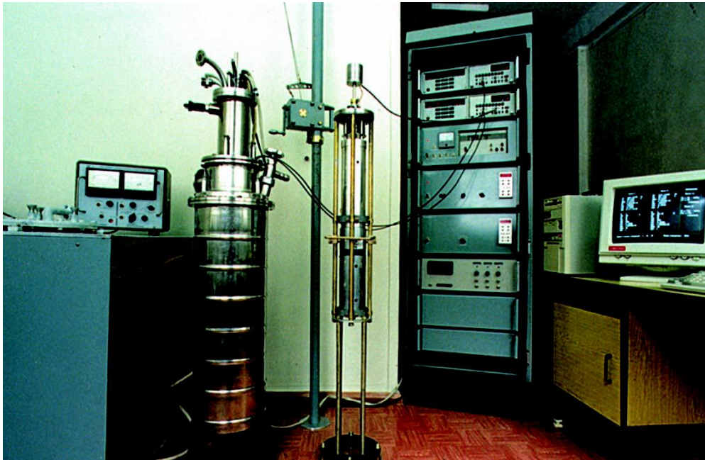
Рис. 3.22. Еталон одиниці температури в діапазоні 13,8 – 273,16 К
