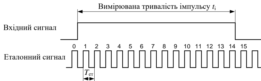
Рис. 17.1. Ілюстрація принципу вимірювання тривалості імпульсу методом сигналу з еталонним періодом слідування
