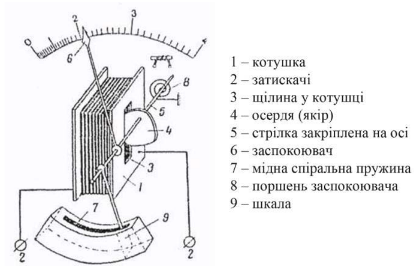
Рис. 3.7. Конструкція вимірювального пристрою електромагнітної системи
