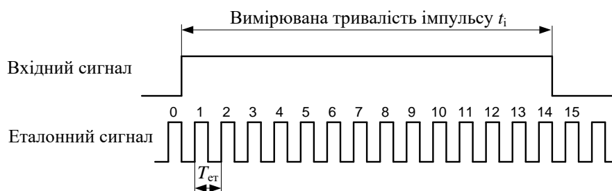
Рис. 16.7. Ілюстрація принципу вимірювання тривалості імпульсу методом сигналу з еталонним періодом слідування
