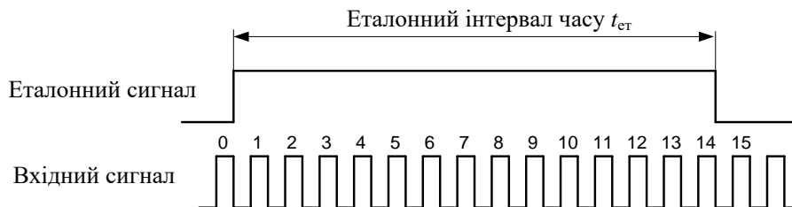
Рис. 16.6. Ілюстрація принципу вимірювання частоти методом еталонного часового інтервалу
