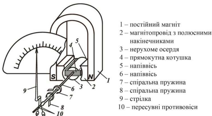
Рис. 3.6. Конструкція вимірювального пристрою магнітоелектричної системи
