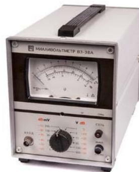
Рис. 3.8. Вольтметр ефективних значень В3-38 з вимірювальним пристроєм магнітоелектричної системи
