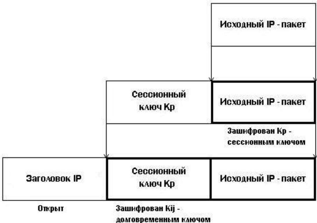
Рис. 5.12. Схема создания SKIP-пакета
