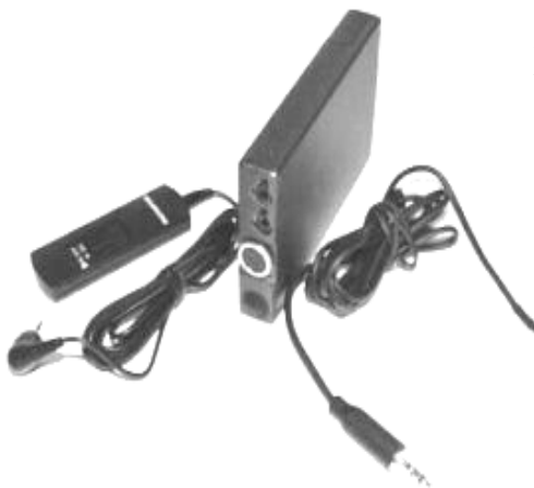
Рис. 1.45. Цифровой бескинематический магнитофон «U-7102»
