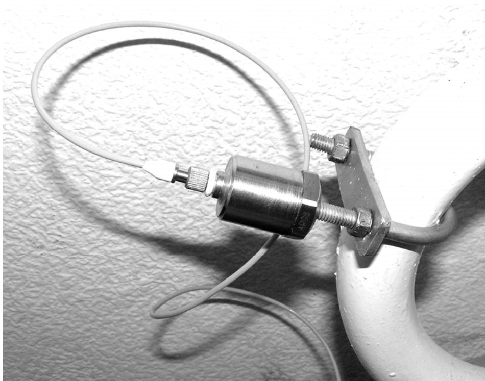
Рис. 4П. Крепление вибродатчика на батарею отопления
