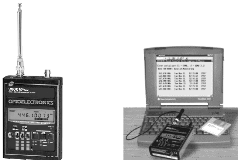
Рис. 3.4. Портативный многофункциональный частотомер «3000A Plus»
