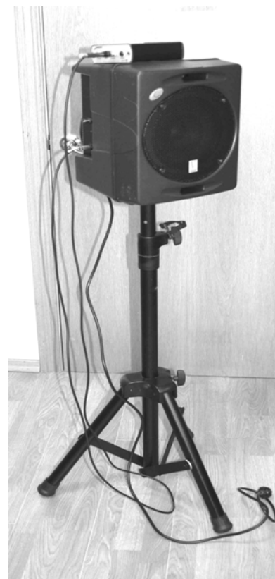
Рис. 10. Внешний вид акустической системы с подключенным модулем тестового акустического сигнала
