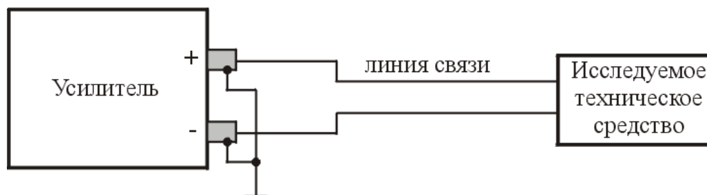
Рис. 1. Симметричная схема подключения
