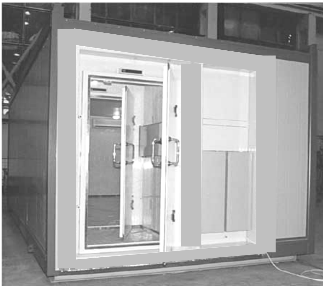
Рис. 4.4. Мобильное экранированное сооружение
