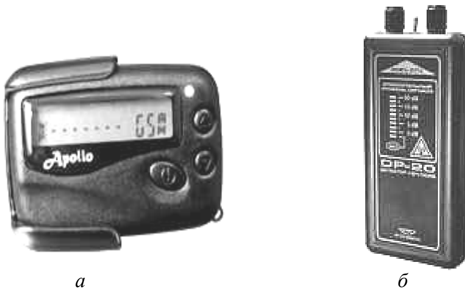
Рис. 3.1. Индикаторы поля: а – частотомер «Оберег», б – «DP-20»
