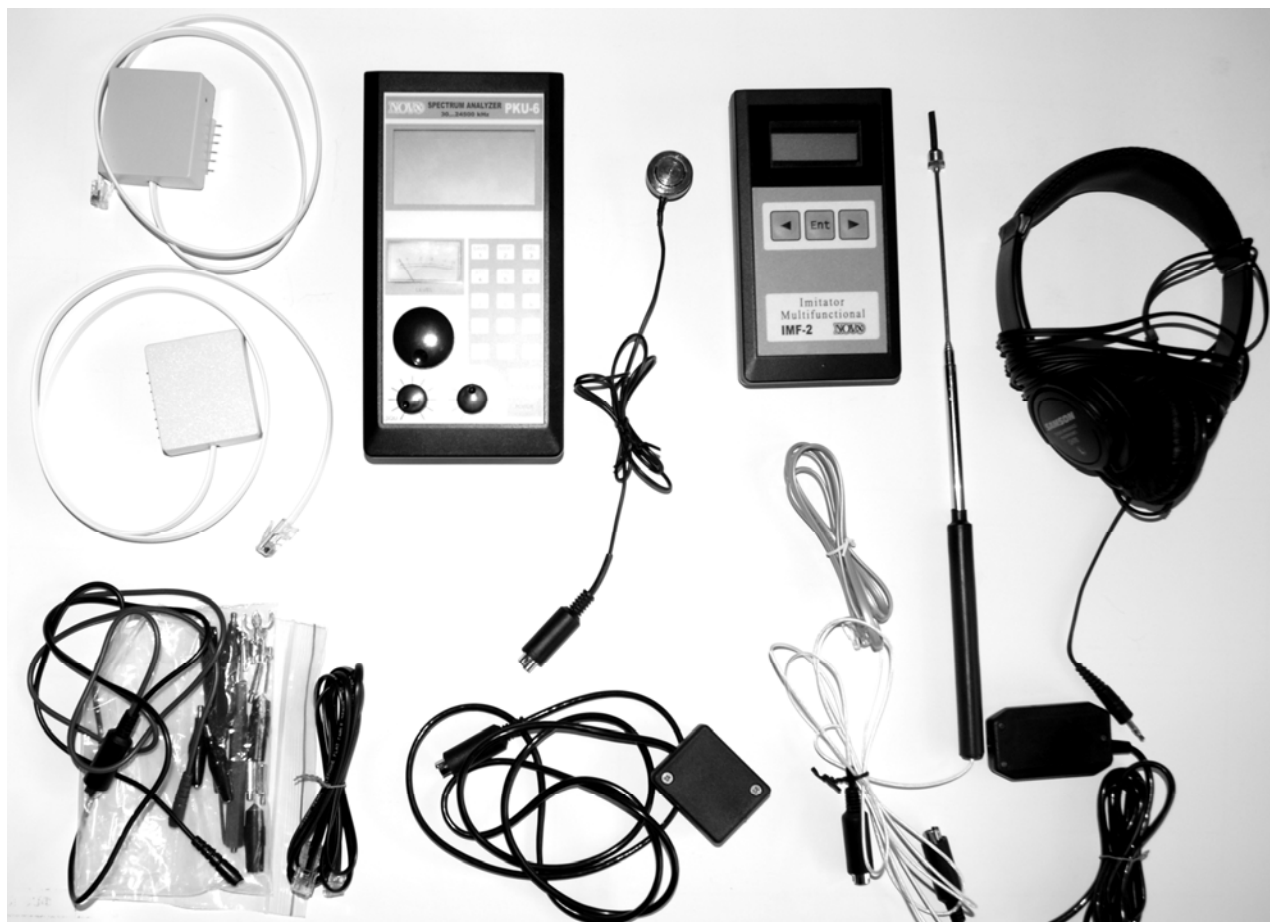
Рис. 3.6. Портативный комплект для обнаружения средств съема информации и выявления каналов ее утечки «ПКУ-6М»
