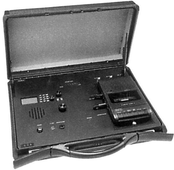
Рис. 27. Сто канальный комплекс, размещённый в атташе кейсе
