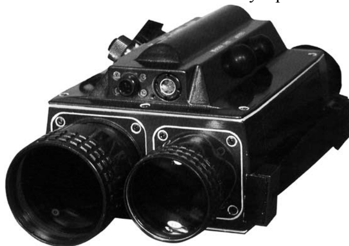
Рис. 72. Активный ночной наблюдательный прибор с импульсной лазерной подсветкой
