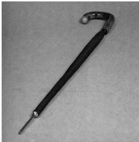
Рис. 49. Трубчатый микрофон закамуфлированный под зонтик
