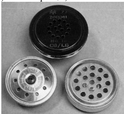
Рис. 109. Радиозакладка в виде телефонного микрофона
