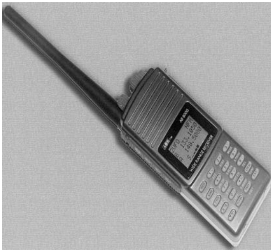
Рис. 28. Панорамный радиоприёмник (AR 8000)
