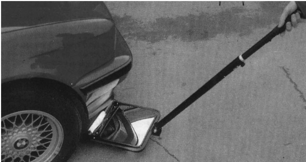
Рис. 123. Зеркало, предназначенные для проведения осмотра в труднодоступных местах
