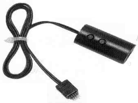
Рис. 61. Пульт дистанционного управления для диктофона EDIC-mini
