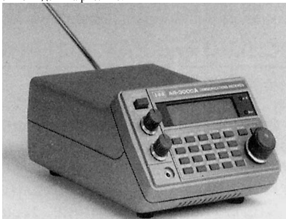
Рис. 140. Панорамный приемник AR-3000A
