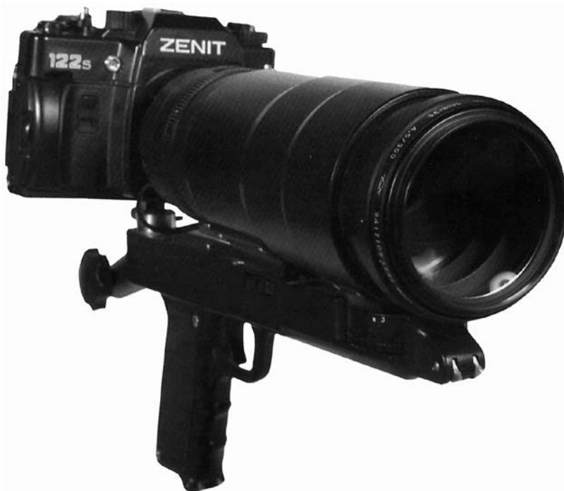
Рис. 77. Фотоаппарат для съёмки с больших расстояний «Фотоснайпер» ФС-122
