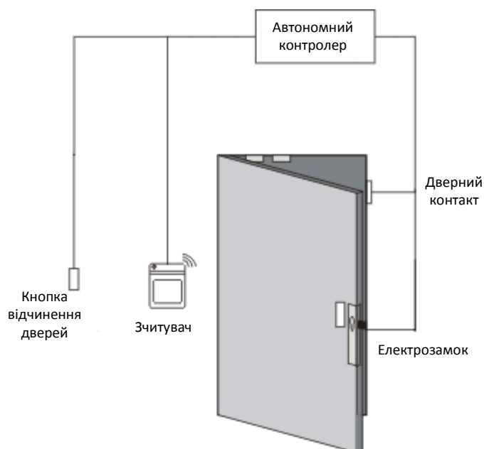
Рисунок 7.10 – Структурна схема автономної СКД
