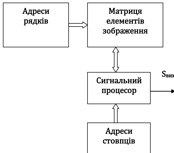
Рис. 2.13 – Структурна схема КМОН-перетворювача
