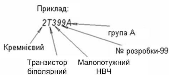
Рисунок 1 – Приклад маркування біполярного транзистора
