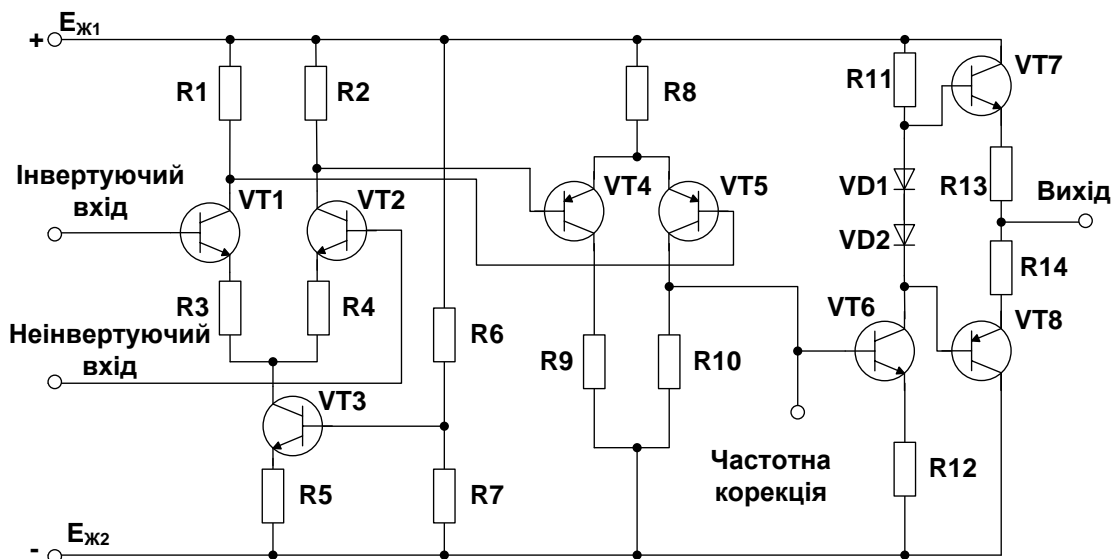
Рис. 2.41. Спрощена принципова схема ІМС ОП
