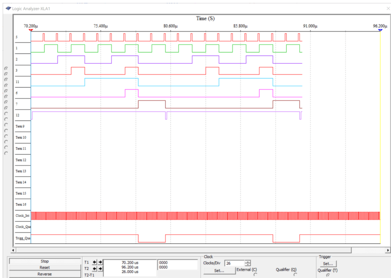
Рис. 11.33. Часові діаграми сигналів у різних точках лічильника з коефіцієнтом ділення частоти K_{\text{діл}} = 10
