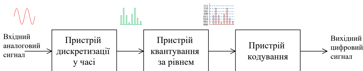
Рис. 20.1. Структура системи для перетворення аналогового сигналу у цифровий код
