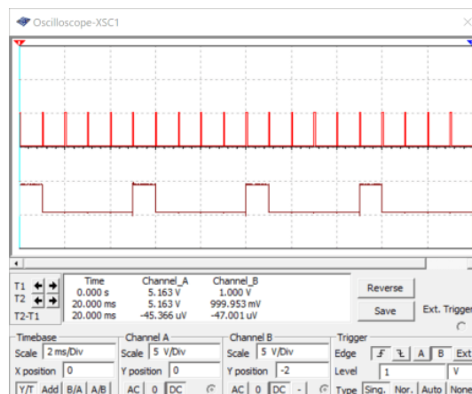
Рис. 10.30. Часові діаграми сигналів на виході генератора тактових імпульсів та на виході перемикача J1 при коефіцієнті ділення лічильника рівному 5
