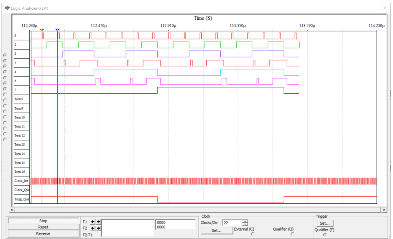
Рис. 11.21. Часові діаграми сигналів урізних точках двійкового лічильника
