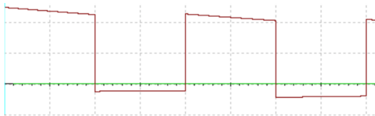
Рис. 3.4. Форма сигналу на резисторі диференціюючого кола при відношенні \tau/t_i = 10
