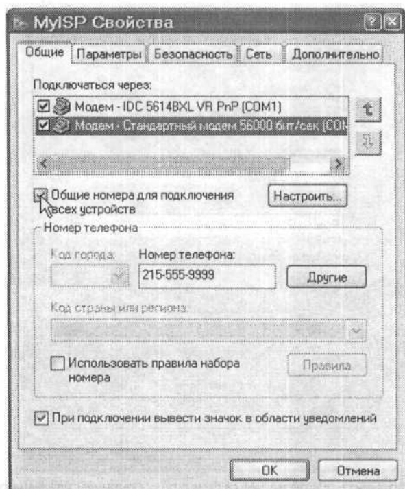
Рис. П.4. Установите флажок рядом со вторым модемом, чтобы разрешить многоканальное подключение
