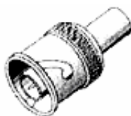
Рис. 1.10. Чтобы избежать появления теневого пакета, к концам коаксиальных сегментов необходимо подключить терминаторы
