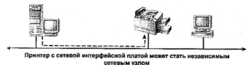
Рис. 8.8. Подключение принтера непосредственно к сети устраняет задержку, возникающую из-за медленного параллельного интерфейса
