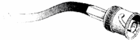
Рис. 1.8. BNC-разъем позволяет соединять коаксиальные кабели друг с другом
