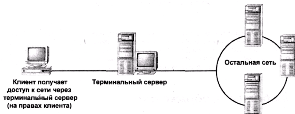
Рис. 12.3. Клиент не ограничен в доступе к терминальному серверу и может использовать общие ресурсы внутри домена
