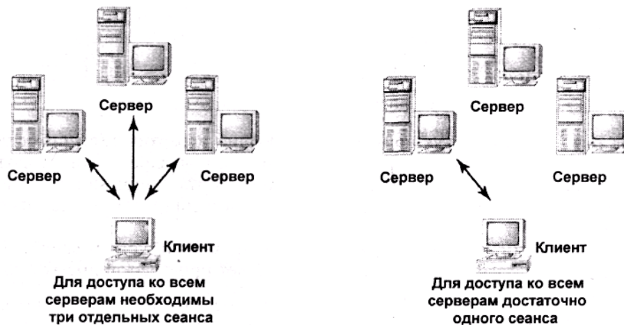
Рис. 10.1. В идеальном случае ресурсы совместно используются группой пользователей, а не отдельным компьютером
