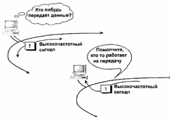
Рис. 2.6. Пересылка пакетов по сети, использующей логическую шинную топологию
