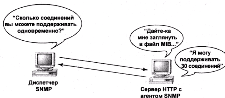
Рис. 14.7. Сетевое взаимодействие по протоколу SNMP между диспетчером и агентом
