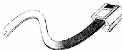
Рис. 1.11. На каждом конце сетевого кабеля UTP находится разъем RJ-45
