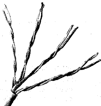
Рис. 8.5. Снимаем внешнюю оболочку кабеля
