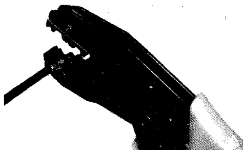
Рис. 7.3. Обжимаем латунный сердечник
