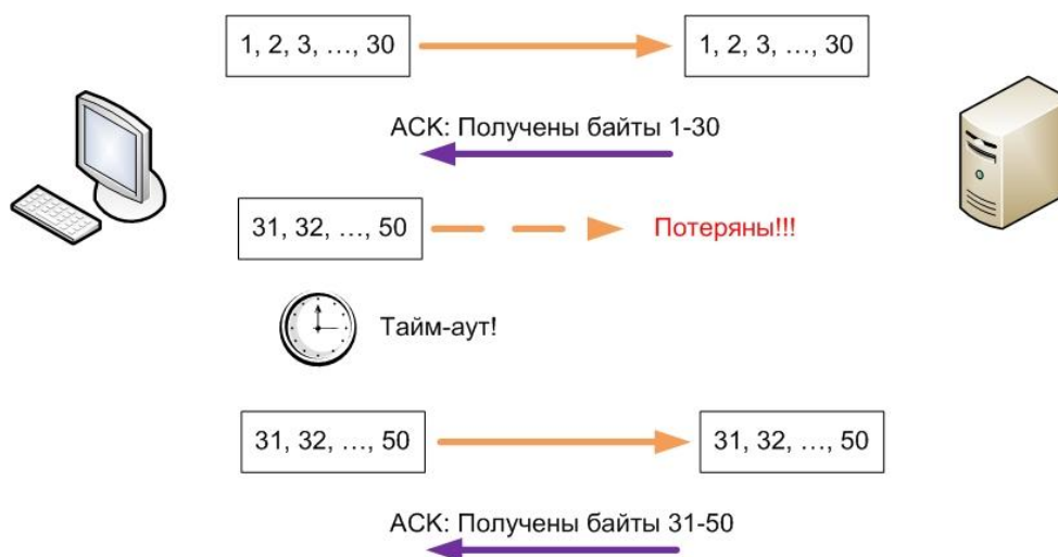
Рис. 112. Позитивное подтверждение с ретрансляцией в TCP
