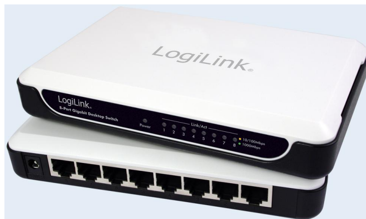
Рис. 6. Концентратор локальной сети
