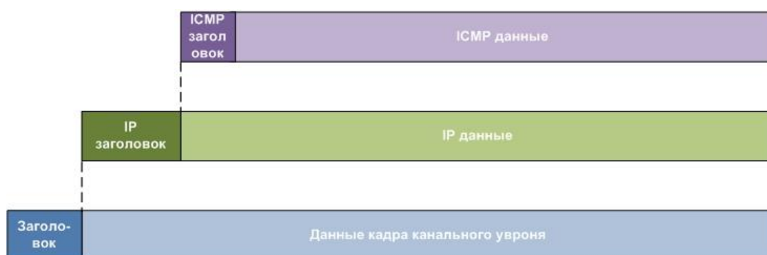
Рис. 103. Схема инкапсуляции сообщений ICMP
