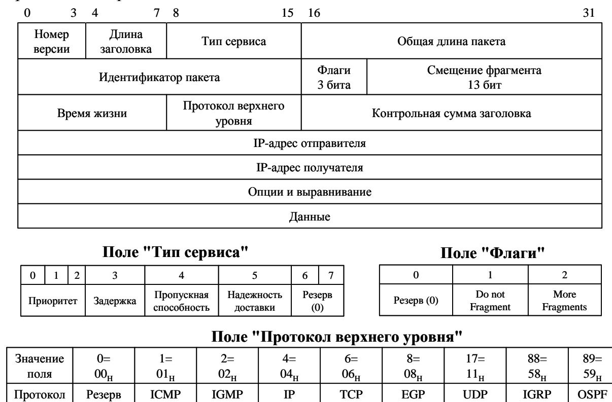
Рис. 96. Структура IP-пакета
