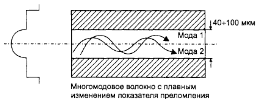
Рис. 8.5, б. Схема распространения сигнала в оптическом волокне
