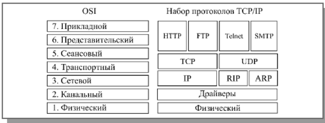
Рисунок 6.4 – Співвідношення рівнів моделі OSI і стека протоколів TCP / IP5
