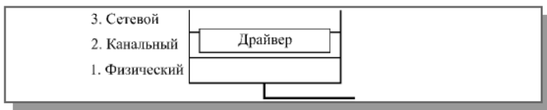
Рисунок 6.1 – Функції драйвера мережевого адаптера в моделі OSI
