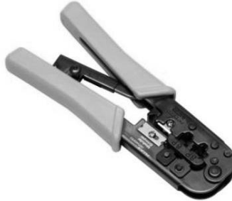
Рис. 33. Кримпер – пристосування для зняття ізоляції й обтискання з'єднувача RJ-45
