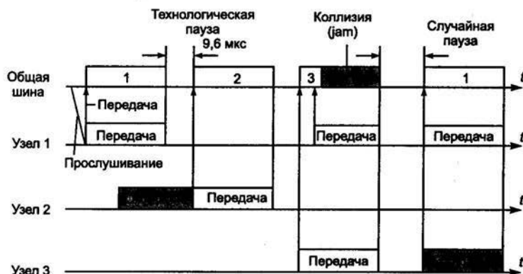
Рис. 4.2. Метод коллективного доступа с опознаванием несущей и обнаружением коллизий CSMA/CD
