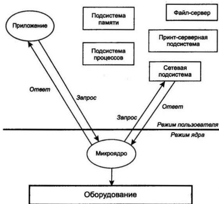
Рис. 6.5. Структура ОС клиент—сервер
