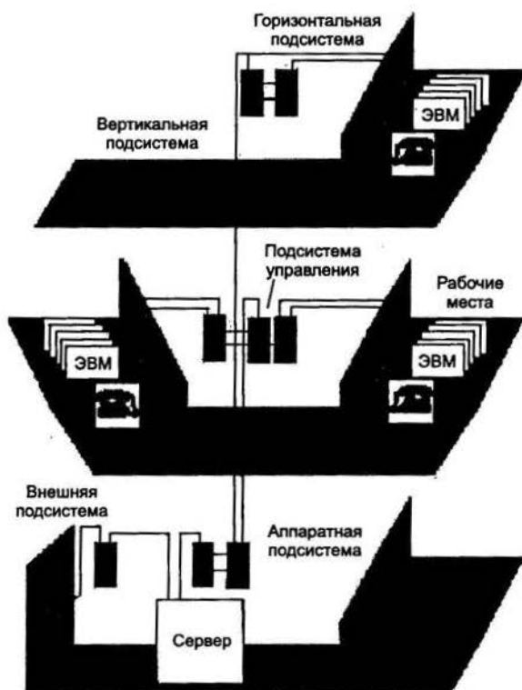
Рис. 4.8. Пример построения структурированной кабельной системы
