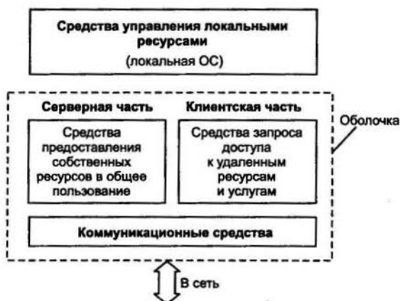
Рис. 6.2. Структура сетевой ОС
