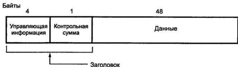
Рис. 5.8. Формат пакета данных ATM
