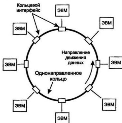
Рис. 4.6. Структура сети на основе маркерного кольца
