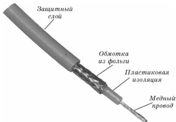
Рис. 4.1. Коаксиальный кабель
