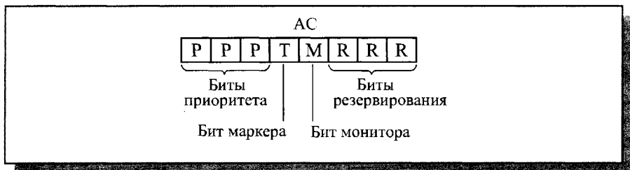
Рис. 7.11. Формат байта управления доступом
