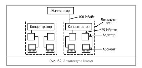
На втором уровне (ярусе) архитектуры располагаются концентраторы, каждый из которых соединяет группу абонентских каналов с одним оптическим каналом, работающим со скоростью 100 Мбит/с и образующим локальную сеть.
