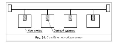
Главным достоинством сетей Ethernet, благодаря которому они стали такими популярными, является их экономичность. Для построения сети достаточно иметь по одному сетевому адаптеру для каждого компьютера плюс один физический сегмент коаксиального кабеля нужной длины.
