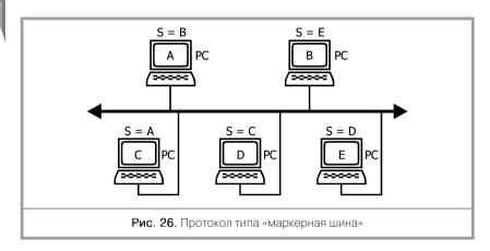
другой станции, которая является очередной по установленному порядку владения правом на передачу. Станции получают маркер в циклической последовательности, при этом в физической шине формируется так называемое логическое кольцо. Работая в режиме прослушивания работы канала, принять передаваемый кадр может только та станция, адрес которой указан в поле адреса получателя этого кадра.
