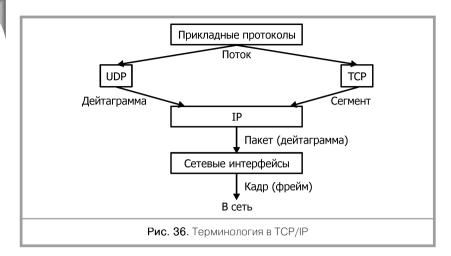
зуется для этой единицы данных в локальной технологии подсети. Для TCP/ IP фреймом являются и кадр Ethernet, и ячейка ATM, и пакет X.25, так как все они выступают в качестве контейнера, в котором пакет IP переносится через составную сеть.
