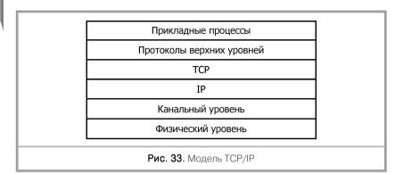
значения блоков данных определенных уровней специального названия кадр (frame), пакет (packet), сегмент (segment). Его задачей являются обеспечение взаимодействия друг с другом и выполнение процессов, связанных с коммутацией и маршрутизацией. Для этого IP передает датаграммы из одной сети в другую. IP относят к сетевому уровню.
