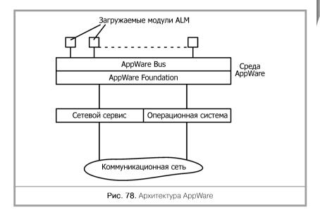
с сетевым сервисом и операционной системой, обеспечивающей выполнение прикладных программ (рис. 78).
