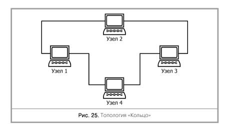
Кольцевая структура обеспечивает довольно широкие функциональные возможности ЛВС при высокой эффективности использования моноканала, низкой стоимости, простоте методов управления, возможности контроля работоспособности моноканала.
