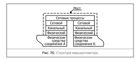
токолы физического (1А, 1В), канального (2А, 2В) и сетевого (3А, 3В) уровней. Специальные сетевые процессы соединяют части коммутатора в единое целое. Физические, канальные и сетевые протоколы в разных сетях различны, поэтому соединение пар коммутационных сетей осуществляется через маршрутизаторы, которые при необходимости преобразуют указанные протоколы.
