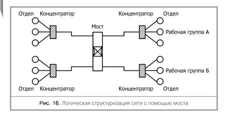
ми располагаются канальные процессы, – рис. 17 (структура моста). Мост опирается на пару связанных им физических средств соединения, которые в этой модели представляют физические каналы. Мост преобразует физический (1A, 1B) и канальный (2A, 2B) уровни различных типов.
