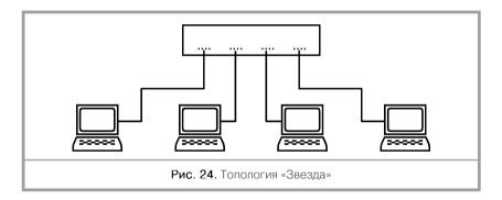
В ЛВС с топологией типа «звезда» в центре находится пассивный соединитель или активный повторитель – достаточно простые и надежные устройства. В функции концентратора входит направление передаваемой компьютером информации одному или всем остальным компьютерам сети.
