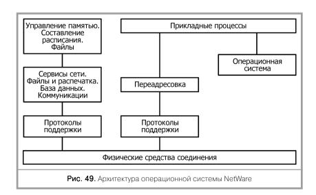
ционная система в основном использует Протокол IPX/SPX. При необходимости загружаемый модуль NetWare (NLM) позволяет серверам и клиентам использовать Протокол управления передачей/ Межсетевой протокол (TCP/IP). По имени операционной системы появились сети NetWare.
