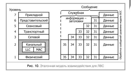
формации процесса свой заголовок – служебную информацию, которая необходима для адресации сообщений и для некоторых контрольных функций. Канальный уровень, кроме заголовка, добавляет еще и концевик – контрольную последовательность, которая используется для проверки правильности приема сообщений из коммуникационной сети.
