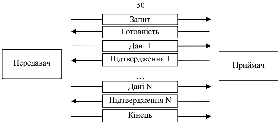
Рис. 32. Приклад обміну пакетами під час сеансу зв'язку
