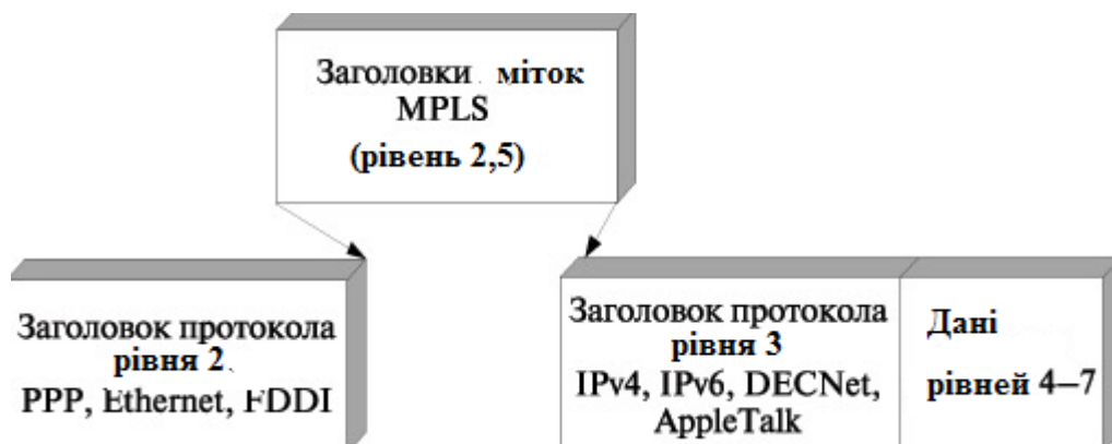
Рис. 4.5 – Принцип інкапсуляції заголовка MPLS
