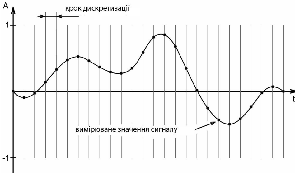
Рис. 1.4. Дискретизація аналогового часового сигналу
