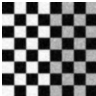
Рис. 3.12. Результат згорткової (а) та частотної (б) фільтрації низьких частот зображення з шумами (рис. 3.11).
