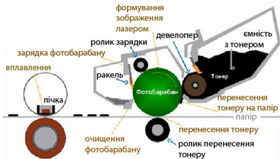
Рис. 3.25. Принцип дії лазерного принтера
