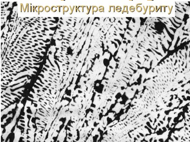
Мікроструктура білого евтектичного чавуну
