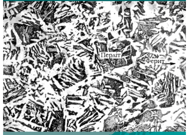
Відманштеттова структура доєвтектоїдної сталі
