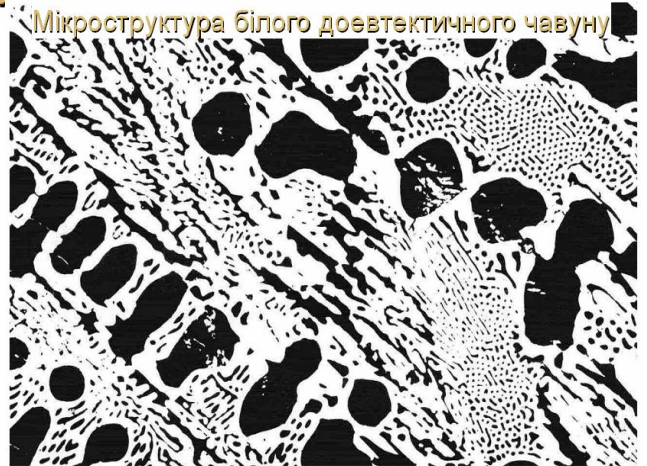
Мікроструктура білого евтектичного чавуну
