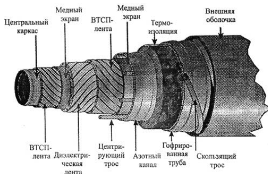
Рис.22. Конструкция типового ВТСП кабеля
