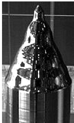
Рис. 7.5. Монокристалл кремния, выращенный по методу Чохральского
