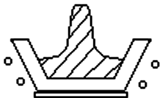
Рис. 8.3. Вытягивание в столбик вещества, расплавленного высокочастотным магнитным полем индуктора, расположенного вокруг тигля
