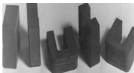
Рис. 5.17 Основные варианты слоистых магнитопроводов для реле РПУ-4 (толщина слоев 0,1; 0,15; 0,2; 0,35 и 0,5 \cdot 10^{-3} м)
