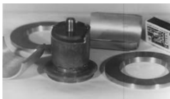
Рис. 4.5 Фрагмент спрессованного ферромагнитного шунта (размер 40 \times 34 \times 65 \cdot 10^{-3} м) в магнитно-импульсном поле
