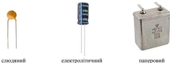
Рис.6.12. Загальний вигляд деяких конденсаторів
