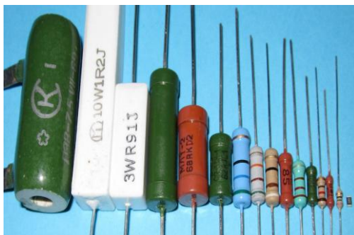
Рис.6.4. Загальний вигляд резисторів постійного опору
