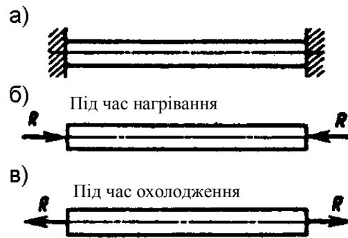
Рисунок 7.19 – Статично невизначені системи залежно від зміни температури
