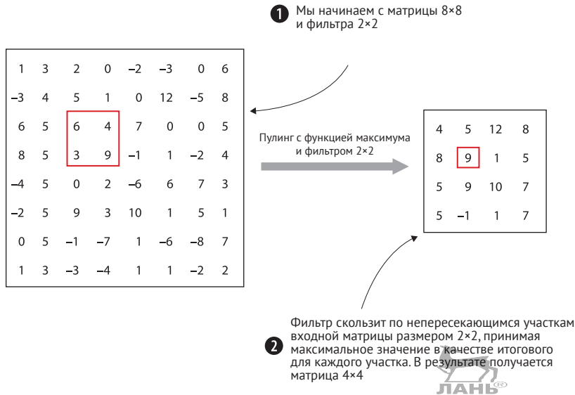
Рис. 6.8 ❖ Уменьшение изображения 8×8 до изображения 4×4 с помощью пулинга с функцией максимума и фильтром 2×2
